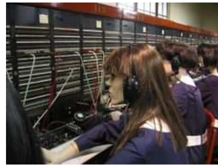
FIGURA 2: Operadoras conmutando llamadas manualmente (se calcula que si el tráfico telefónico actual tuviese que ser conmutado manualmente, toda la población mundial sería insuficiente para hacerlo).
